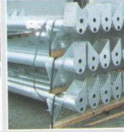
Salidas con roscas interiores como parte integral del caño (sin soldaduras) evitan pérdidas de agua.
